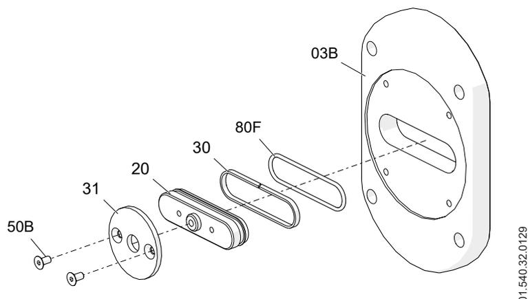
8. Desenroscar los tornillos (50B) del anillo base del pistón interior (31A).
