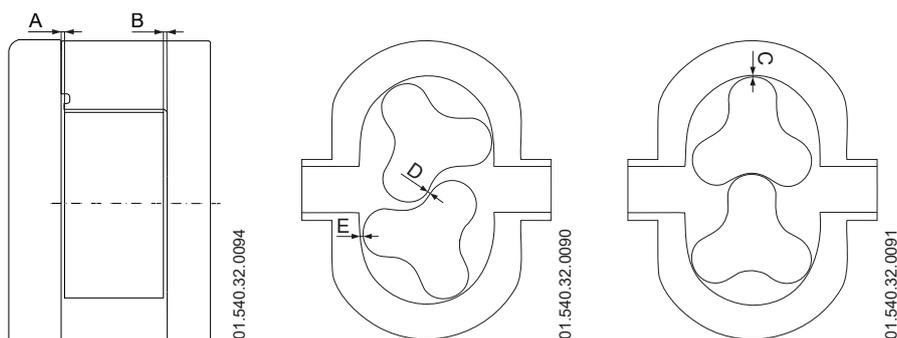
En la siguiente tabla se detallan las distancias requeridas para la sincronización y el ajuste de los rotores.
