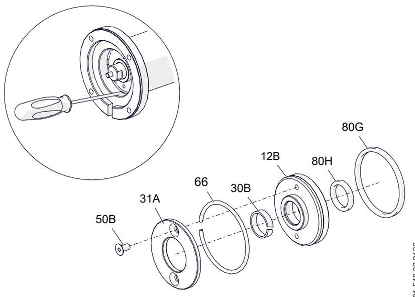
13. Sacar el conjunto del pistón interior (20A) del cuerpo del bypass (01A).
