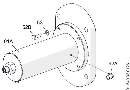
4. Separar, entre ellos, la tapa y el cuerpo del bypass (01A) hasta que se pueda colocar una llave fija de 17 mm para desenroscar el conjunto tapa + pistón del resto del by-pass.
